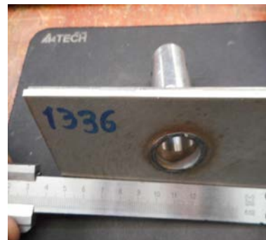
Рис. 2. Зразок зварного з'єднання № 1336 типу «пластина-труба»
